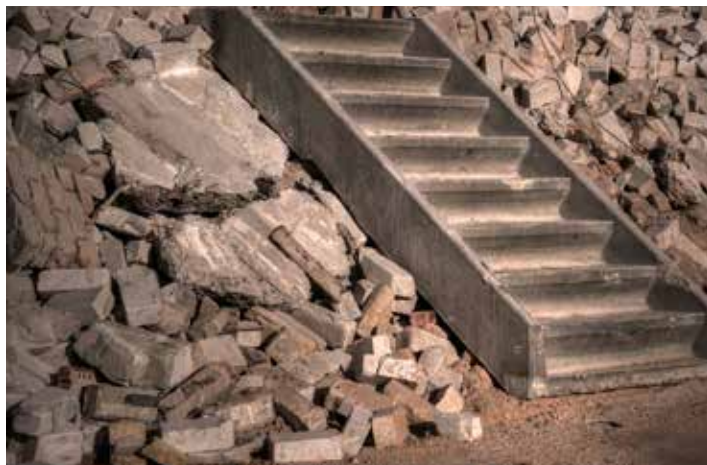
Betonrecycling: Eine neue Technologie bindet CO 2 in den Poren von Betongranulat als Kalkstein. Recyclingwerke können dieses aufgewertete Granulat als Kiesersatz dem frischen Beton zumischen. Dadurch benötigt man weniger Zement – bei gleichbleibenden Eigenschaften. Bild: pixabay
